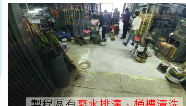
電鍍槽為地下形式、曾發生洩漏
