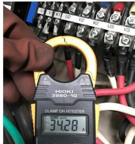
織廠空調250RT冰機-冷卻水泵 電壓、電流及消耗功率(P1)
