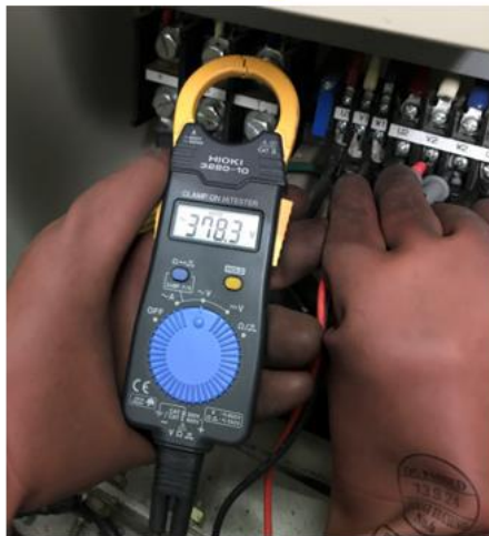
織廠空調250RT冰機-冷卻水泵 電壓、電流及消耗功率(P1)
