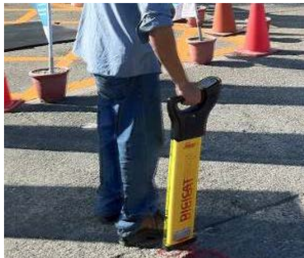
管線探測儀探測 (電管)
