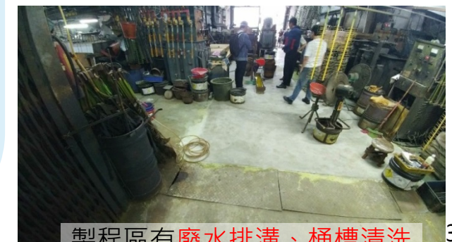
電鍍槽為地下形式、曾發生洩漏
